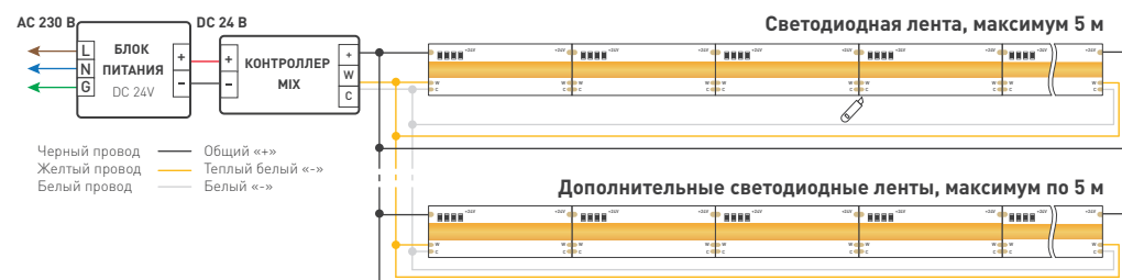
Схема 1. Подключение нескольких светодиодных лент с двух сторон
