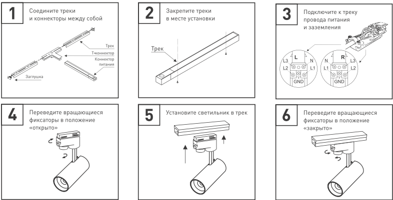
Рис. 2. Установка и подключение светильника
